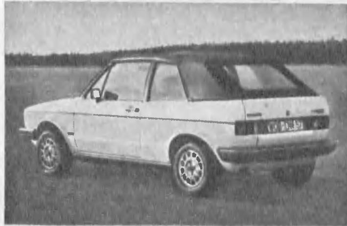
Подъемные боковые стекла не имеют рамок. В двери направляющими для стекла служат стойка поворотной форточкой и канавка в передней кромке дуги. У заднего стекла — лишь одна направляющая (в задней кромке защитной дуги).
