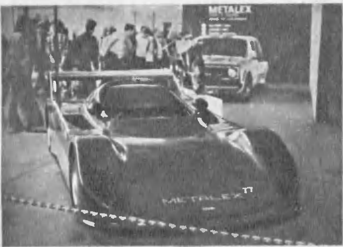
Спортивный автомобиль «Металэкс-203» с новым двигателем (в 1977 году на нем стоял форсированный до 125 л. с. двигатель ВАЗ-21011).
